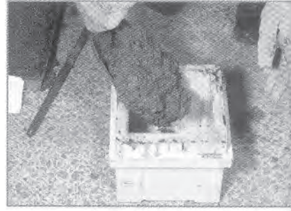
Kepçeyle kalıba boşaltma
