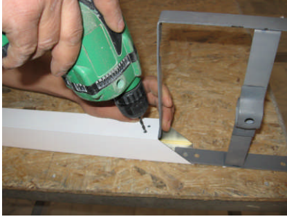
Resim 2.20: Dikme ve başlık demirine perçin deliklerinin delinmesi
