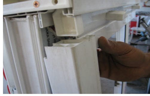
Resim 3.31: Yan kanal profillerinin pencere kasası üzerine konarak vidalanması
