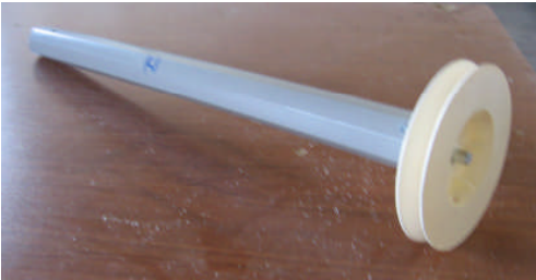
Resim 3.15: Mono blok panjur başlık kutusu elemanları ve tambur borusu
