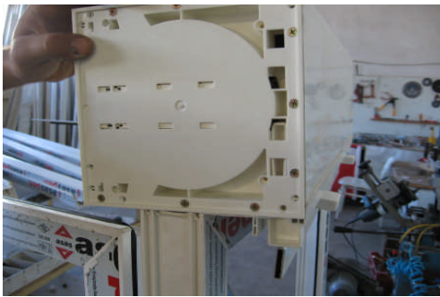
Resim 3.30: Panjur kutusunun pencere kasası üzerine konularak vidalanması
