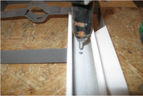
Resim 2.7: Yan kanal profilinin kısa tarafının dikme üzerine perçinlenmesi
