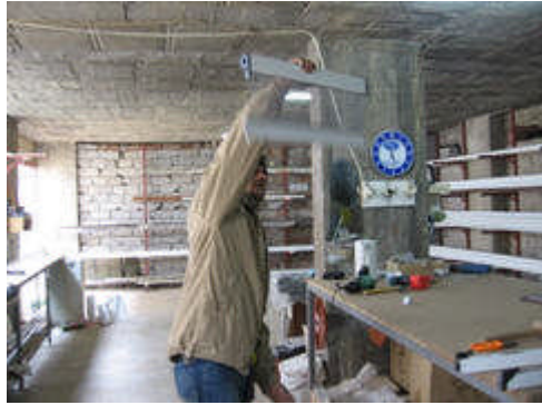
Resim 4.27: Sineklik telinin açılarak kontrol edilmesi
