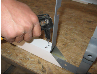
Resim 2.1: Perçinin pensesine takılması ve başlık demirinin perçinlenmesi
