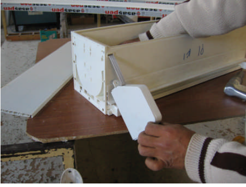
Resim 3.22: Panjur ipinin kasnak üzerine birkaç tur sarılması
