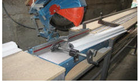
Resim 4.13: Kesim için makine siperinin ayarlanması
