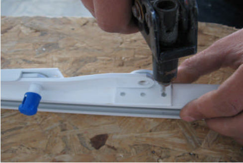
Resim 2.6: Dışa açılım makasının kanal profiline perçinlenmesi
