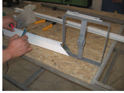
Resim 2.2: Yan kanal profil boyunun belirlenmesi
