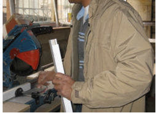
Resim 4.16: Yan kanal profillerinin kesilmesi
