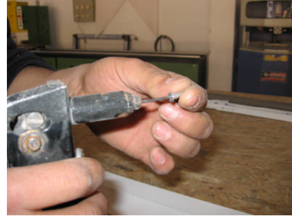
Resim 2.1: Perçinin pensesine takılması ve başlık demirinin perçinlenmesi
