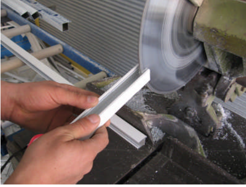
Resim 2.3: Yan kanal profillerinin boylarının kesilmesi ve kısa parçanın çürütülmesi
