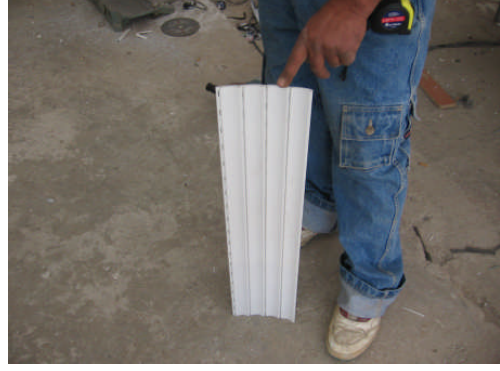
Resim 3.16: Lamellerin birleştirilerek panonun oluşturulması
