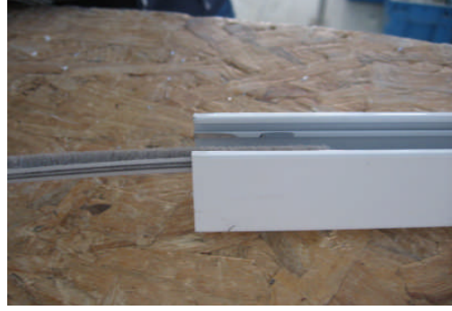
Resim 2.5: Yan kanal profillerine fitillerin takılması
