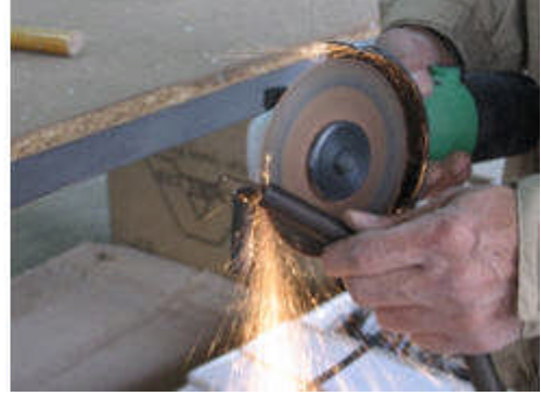
Resim 4.22: Fazlalıđın yay ve borusu üzerine iřaretlenerek yayın kesilmesi
