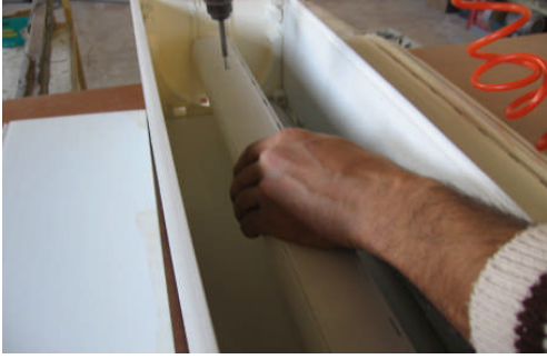
Resim 3.25: Panjur panosunun tambur borusuna vidalanması
