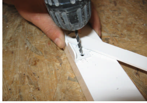
Resim 2.9: Makasın dikmeye perinlenmesi
