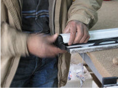
Resim 4.26: Yayın sarılmasından sonra toplayıcının yerine yerleştirilmesi
