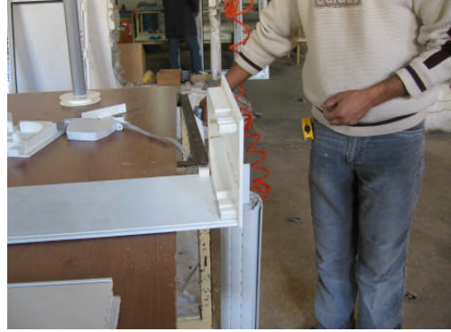
Resim 3.17: Kutu alt parçasına başlık yan kapakların vidalanması
