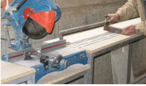
Resim 4.13: Kesim için makine siperinin ayarlanması
