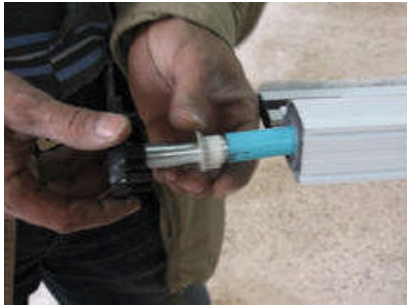
Resim 1.21: Hız ayarlayıcı (fren) aparatın takılması
