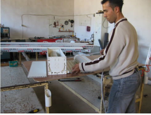
Resim 3.26: Lamel uçlarının aynı hizaya getirilmesi
