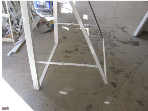
Resim 2.12: Yapımı tamamlanmış dikme ve yan kanallar
