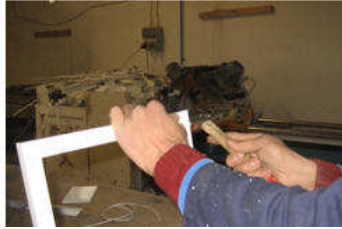
Resim 4.11: Köşe bağlantılarının takılarak çerçevenin oluşturulması
