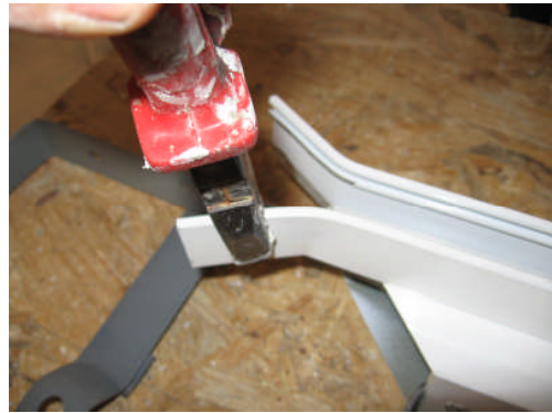
Resim 2.10: Yan kanal giriř ađzının geniřletilmesi
