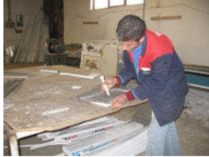
Resim 5.6: Lastik fitil ucunun tutturulması
