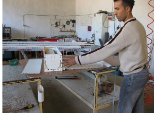
Resim 3.27: İpin çekilerek panonun tambur borusuna sarılması
