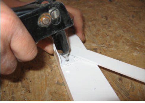
Resim 2.9: Makasın dikmeye perinlenmesi
