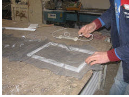
Resim 5.5: Çerçeve üzerine sineklik telinin konulması
