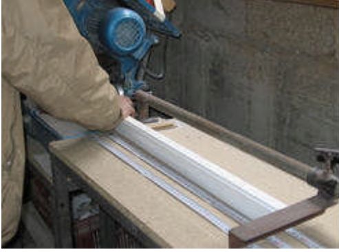
Resim 4.16: Yan kanal profillerinin kesilmesi
