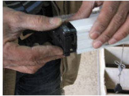
Resim 1.21: Hız ayarlayıcı (fren) aparatın takılması
