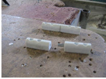
Resim 5.12: Sineklik çerçevesinde kullanılan menteşeler
