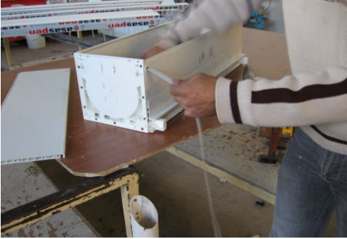
Resim 3.23: İpin aparatından boşaltılarak kasnak üzerine sarılması
