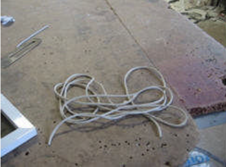
Resim 5.3: Lastik fitil ve fitil takma aparatı
