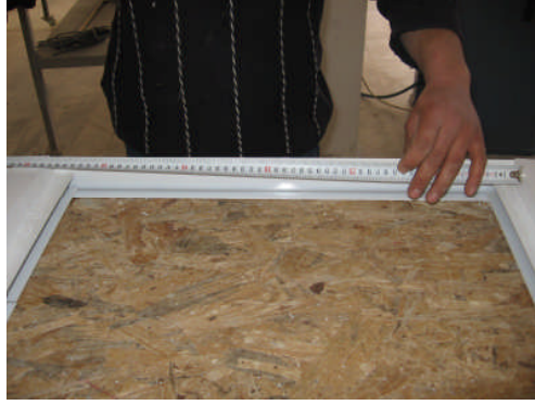
Resim 33: Lamel boylarının belirlenmesi
