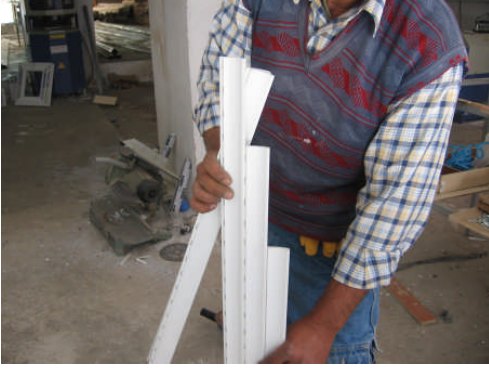
Resim 3.16: Lamellerin birleştirilerek panonun oluşturulması
