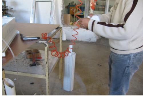
Resim 3.23: İpin aparatından boşaltılarak kasnak üzerine sarılması
