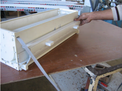
Resim 3.27: İpin çekilerek panonun tambur borusuna sarılması
