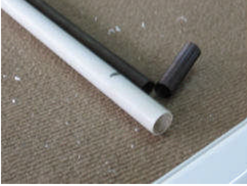
Resim 4.22: Fazlalıđın yay ve borusu üzerine iřaretlenerek yayın kesilmesi
