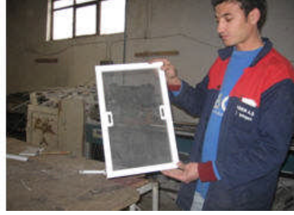
Resim 5.11: Tutamakları vidalanmış çerçeve
