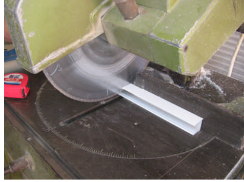
Resim 2.3: Yan kanal profillerinin boylarının kesilmesi ve kısa parçanın çürütülmesi
