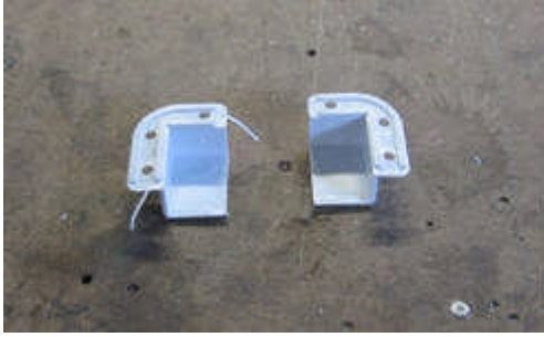
Resim 5.15: Sabit sineklik tutturma aparatları
