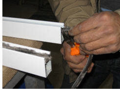
Resim 4.17: Yan kanal profillerine fitilin takılması
