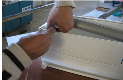
Resim 3.21: Panjur ipinin takılması
