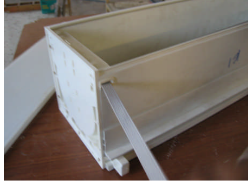
Resim 3.22: Panjur ipinin kasnak üzerine birkaç tur sarılması
