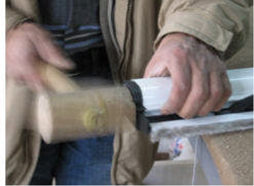
Resim 4.26: Yayın sarılmasından sonra toplayıcının yerine yerleştirilmesi
