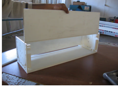
Resim 3.19: Kutu üst parçasının yerine vidalanması
