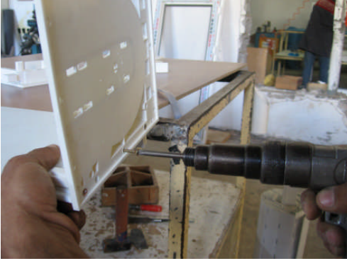
Resim 3.17: Kutu alt parçasına başlık yan kapakların vidalanması
