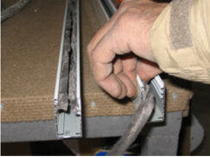
Resim 4.17: Yan kanal profillerine fitilin takılması
