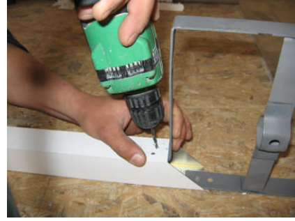
Resim 2.20: Dikme ve başlık demirine perçin deliklerinin delinmesi
